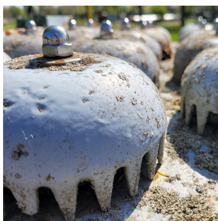
Abb. 3: Glockenboden einer Destille
