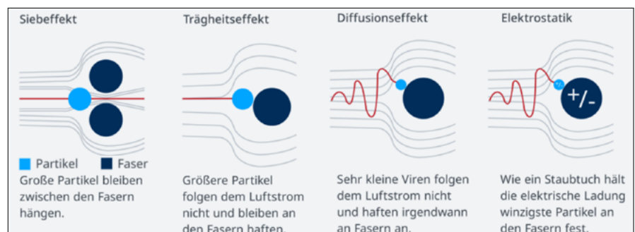
Abb. 1: Physikalische Mechanismen, welche für die Filterwirkung von Tiefenfiltern eine Rolle spielen. [10] © medicalsafety-reifenhauser.com
