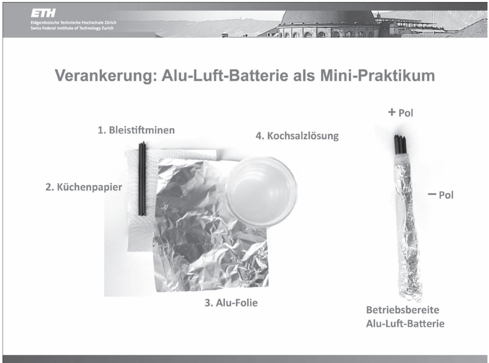
Abb.2: Bestandteile der Alu-Luft-Batterie und zusammengebaute Version
